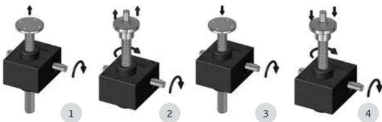
Prestare particolare attenzione in caso di più martinetti assemblati sulla stessa trasmissione. In questo caso è consigliato verificare sul catalogo generale la sezione dedicata agli schemi di montaggio, ricordando che gli stessi sono validi per sensi di rotazione destri.
